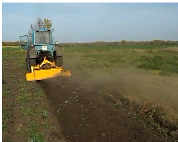
Рисунок 5 –Ротационный плуг, имеющий механический привод
