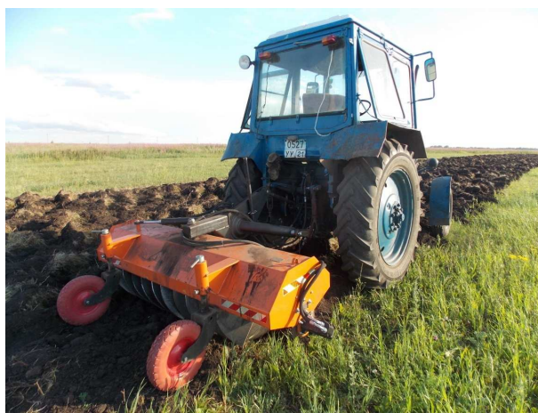
Рисунок 4 –Ротационный плуг, имеющий гидравлический привод
