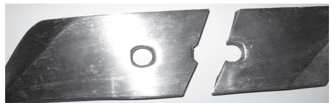
Рис. 3. Излом оборотного долота по концентраторам напряжений
