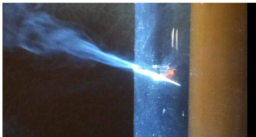
Рис. 3. Задымление установки при полном перекрытии байпасной камеры
