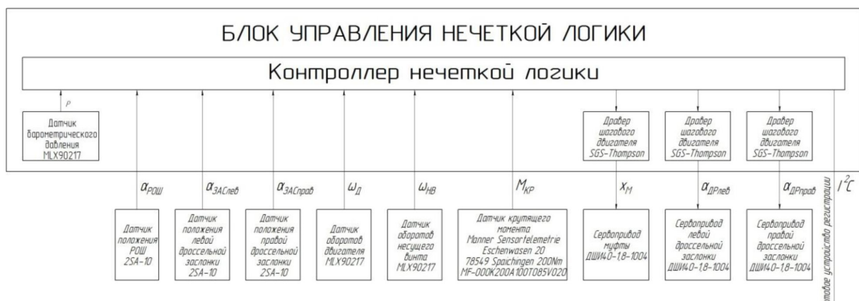
Рисунок 1. Структурная схема системы автоматического управления частоты вращения несущего винта
