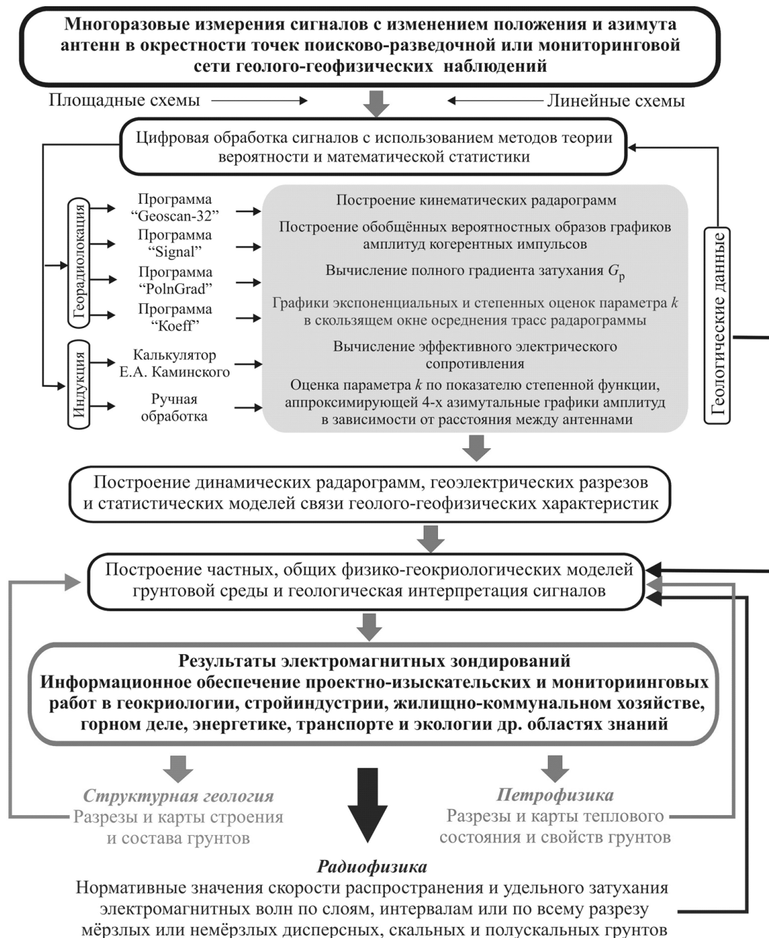
Рис. 3. Общая структура новой электромагнитной технологии всестороннего изучения мерзлых грунтов криолитозоны России [2]
