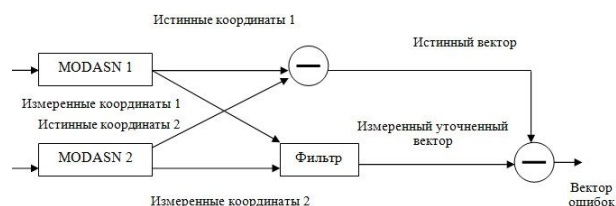
Рис. 7. Структура математического стенда для моделирования относительной навигации с фильтрацией
