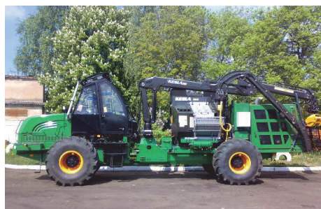
Рис. 1. Объект исследовательских испытаний – мобильная рубильная машина АМКОДОР 2904
