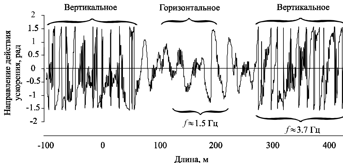
Рис. 3. Направление действия полного ускорения при движении в кривой со скоростью 160 км/ч
