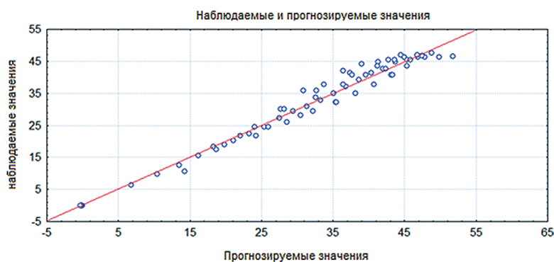
Рис. 3. График соответствия расчетных и опытных значений влияния напряжения между электродами U (В) и длительности обработки T (ч) на количество отведенной влаги G (кг)
