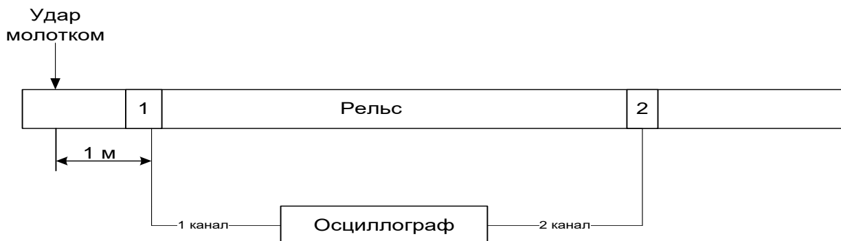
Рис. 2. Схема эксперимента, где 1, 2 – пьезоэлектрические датчики
