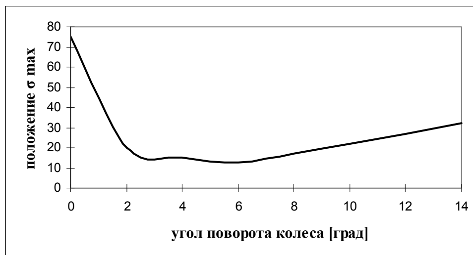
Рис. 9. График зависимости местоположения зоны с максимальными изгибными напряжениями от угла поворота колеса
