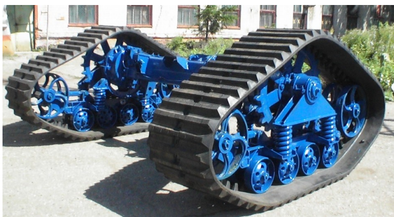
Рис. 3. Шасси полугусеничное с резиноармированными гусеницами
