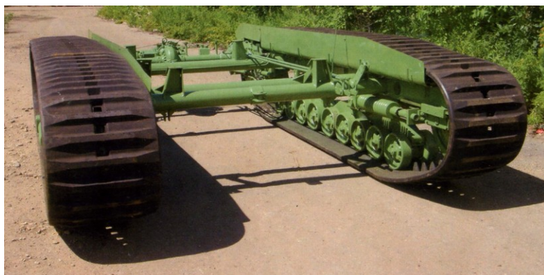
Рис. 1. ГХТ типа ТГР-3 на полужесткой рычажно-пружинной подвеске
