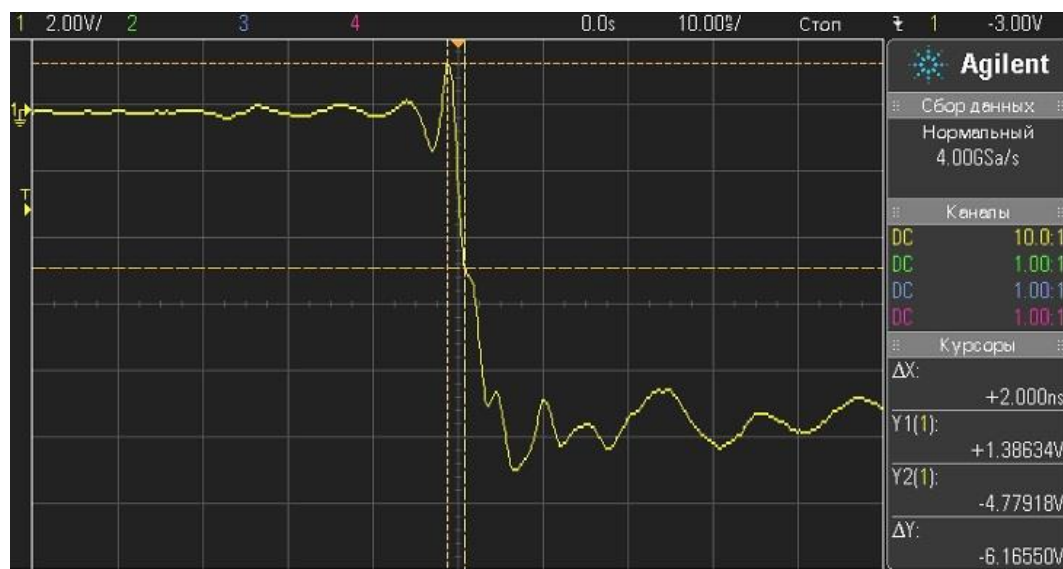
Рис. 8. Осциллограмма перспективного диода КРЕМНИЙ (в корпусе КТ-47): форма волны напряжения – желтая. Амплитуда импульса обратного напряжения, приложенного через диод V_A=900 В. dV/dt=308 В/нс
