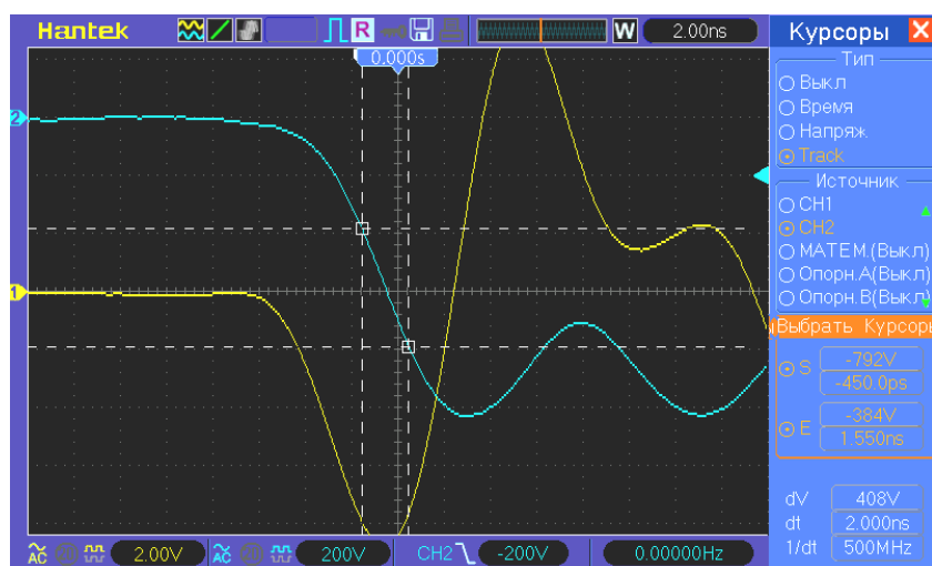
Рис. 5. Осциллограмма для диода C4D10120: форма волны напряжения – голубая (верхняя), форма тока – желтая (нижняя). Амплитуда импульса обратного напряжения, приложенного через диод V_A=900 В. dV/dt=204 В/нс
