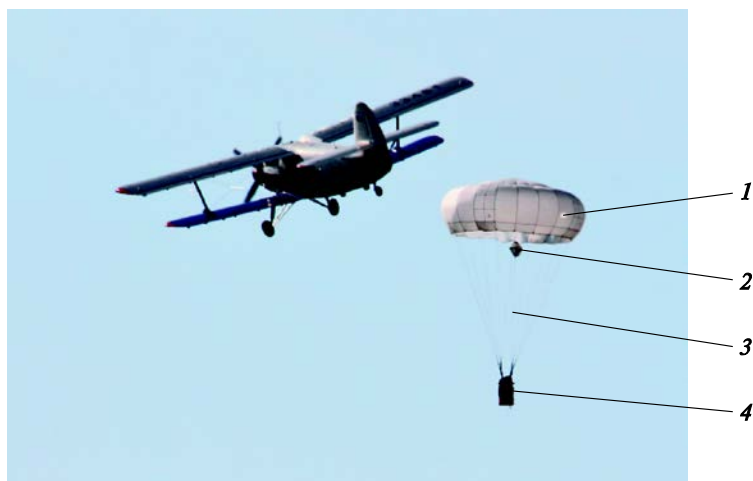
Рис. 18. Макетная парашютная система при F_n = 25 \text{ м}^2 :
