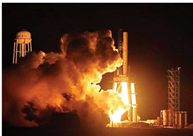
Рис. 7. Огневые технологические испытания первой ступени ракеты-носителя Falcon-9
