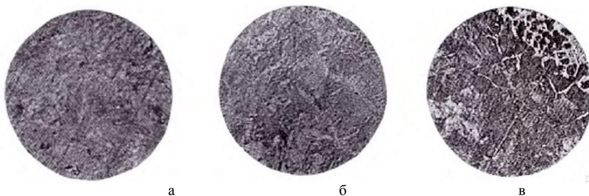
Рис. 1. Микроструктура оплавленного участка стали У10 ( \times 250 ) после аргоно-плазменной (а), воздушно-плазменной (б) и кислородно-флюсовой резки (в)
