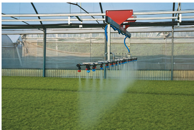
Рис. 6. Подвижная верхняя спринклерная система
