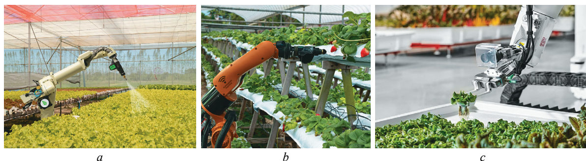
Рис. 8. Применение промышленных роботов в сити-фермах: а – полив; б – определение спелости урожая; с – сбор урожая
