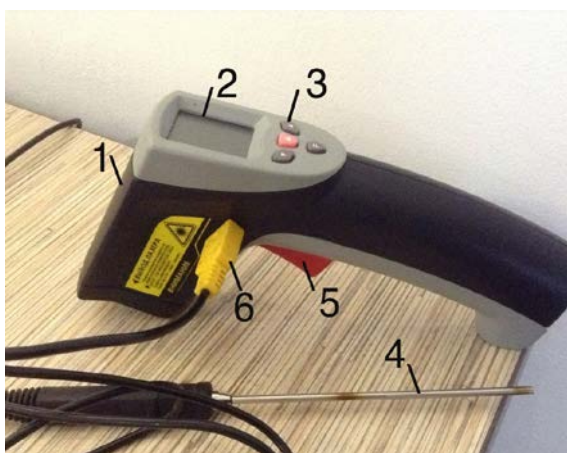
Рис. 1. Общий вид используемого пирометра: 1 – пирометр; 2 – экран пирометра; 3 – управляющие кнопки пирометра; 4 – термопара; 5 – кнопка включения лазерного указателя; 6 – подключение термопары
