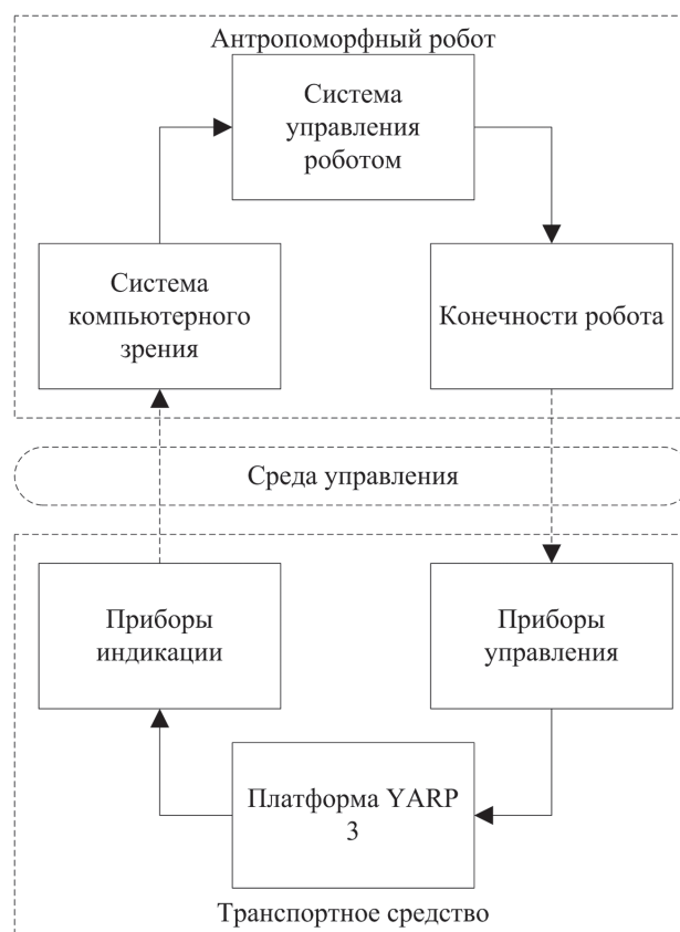
Рис. 1. Схема взаимодействия компонентов разрабатываемой системы
