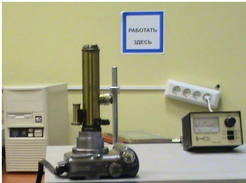
Рис. 8: Оптическая часть установки и КСВ - метр.
