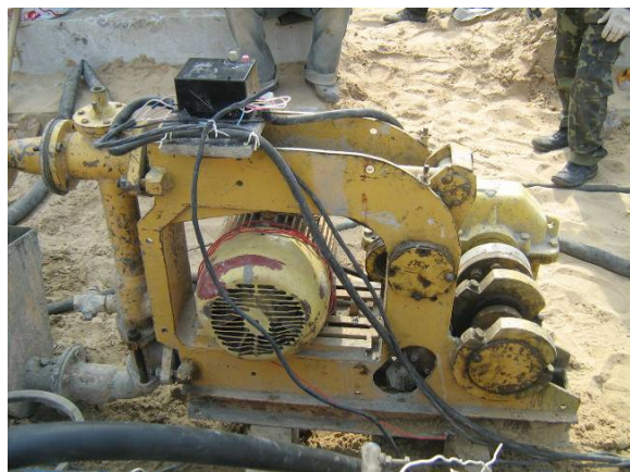
Рис. 8. Противоточный двухпоршневой растворобетонасос с шаровыми клапанами и вертикальной колонкой
