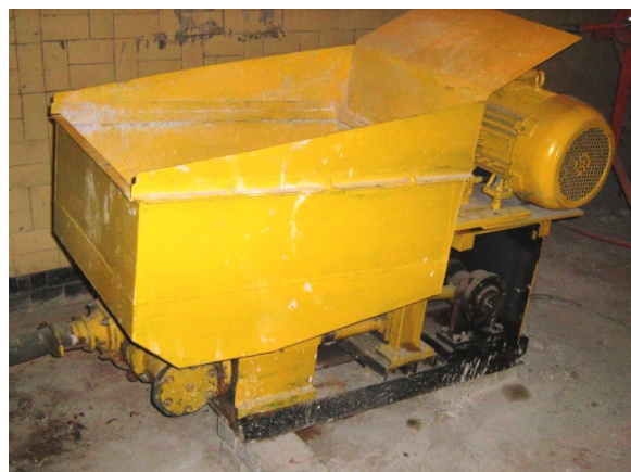
Рис. 11. Двухпоршневой растворобетононасос с тарельчатыми клапанами и горизонтальным расположением цилиндров
