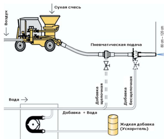
Рис. 3. Технологическая схема торкретирования сухим способом
