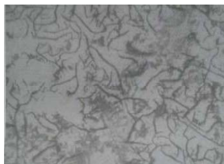
Рис. 1. Исходная микроструктура серого чугуна, \times 100
