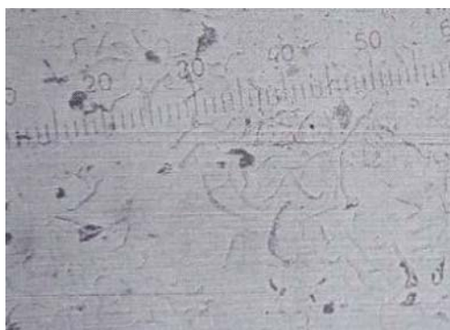
Рис. 3. Микроструктура поверхностного слоя чугуна после диффузионного хромирования на нетравленных шлифах: а - граница перехода диффузионного слоя к основной структуре чугуна; б - включения графита в диффузионном слое, \times 300
