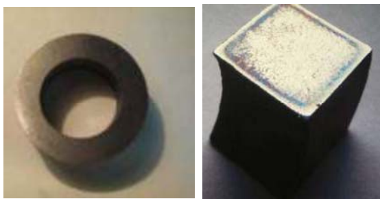
Рис. 2. а - внешний вид детали; б - макроструктура поперечного сечения детали, \times 2
