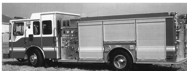
РИС.5. Традиционная компоновка американских пожарных автомобилей на спецшасси, созданных по “кооперативной” технологии (из комплектующих компонентов различных фирм)
