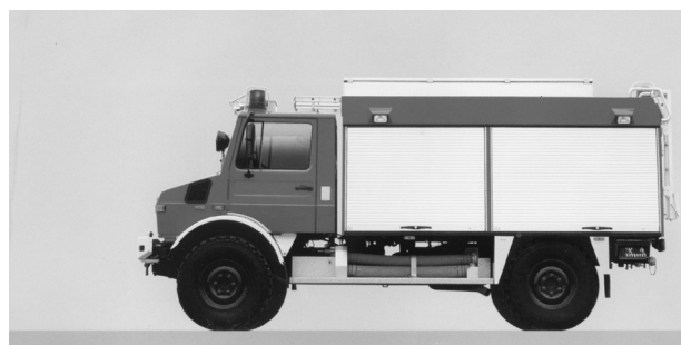
РИС.2. Пожарные автоцистерны на шасси Mercedes среднего класса Atego ( верхний снимок ) и внедорожник Unimog ( нижний снимок )
