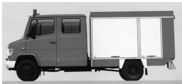
РИС.1. Пожарные автомобили первой помощи на шасси Mercedes легкого класса ML 320 (полная масса 2750 кг, верхний снимок ), Sprinter (полная масса 3500 кг, средний снимок ) и Vario (полная масса 7490 кг, нижний снимок )
