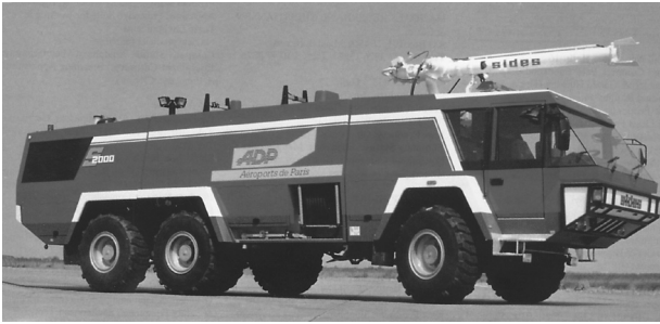
РИС.6. Аэродромный пожарный автомобиль тяжелого класса фирмы Sides на специальном шасси, созданном фирмой
