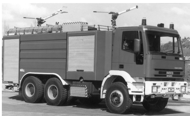
РИС.3. Пожарные автомобили тяжелого класса на шасси с капотной (фирма Sides, верхний снимок) и бескапотной (фирма IVECO-Magirus, нижний снимок) компоновками
