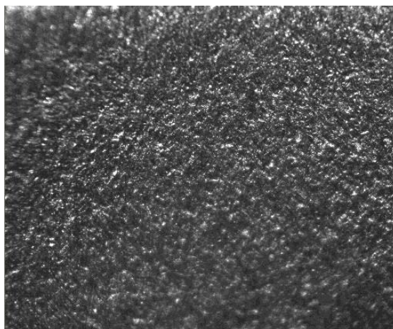
Рис. 7. Поверхность детали из порошкового молибденового сплава после обработки абразивным потоком
