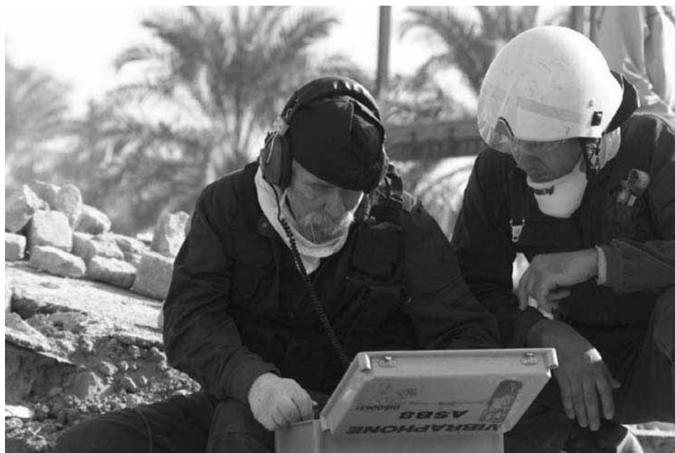
Рис. 2. Определение координат пострадавшего в завале
