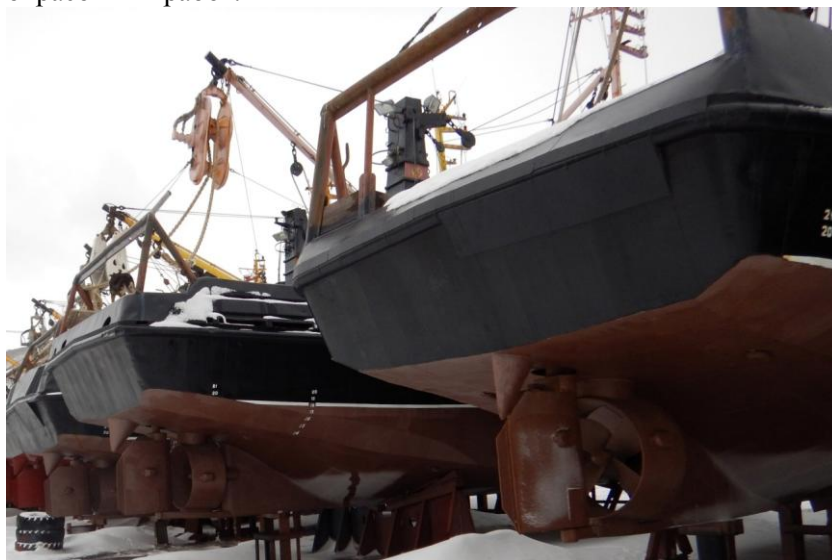
Рис. 3. Прошедшие ремонт маломерные суда типа МРС-150. Протекторы полностью покрашены
