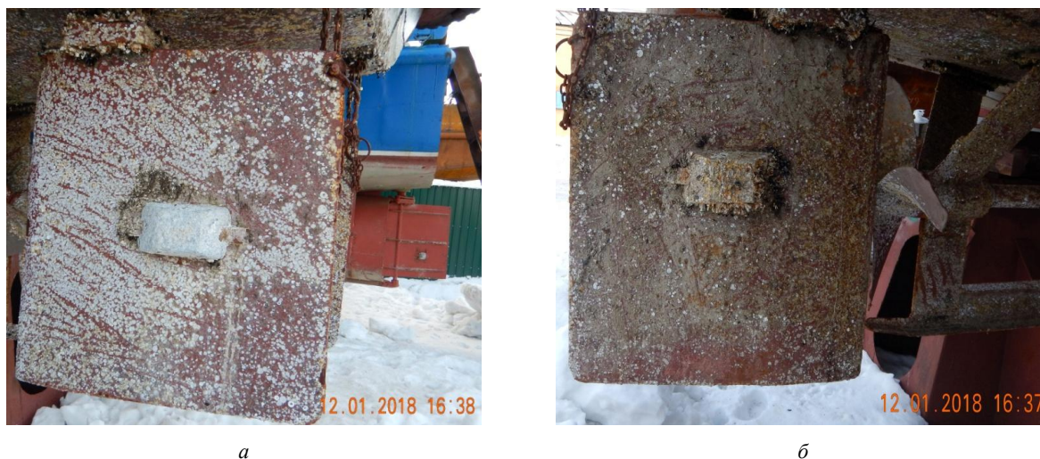
Рис. 2. Внешний вид протекторов на конструктивно схожем катере проекта 376: а – работоспособный протектор П-КОА-5 на левом пера руля, не покрытый биообрастанием и растворявшийся в морской воде; б – неработоспособный протектор П-КОА-5 на правом пера руля, оброс баянусами и мидиями, в морской воде не растворялся
