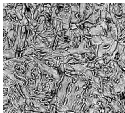
Рис. 5. Морфология выделения бейнитной составляющей в структуре металла ОШУ ЗТВ стали K70 после воздействия двух проходов
