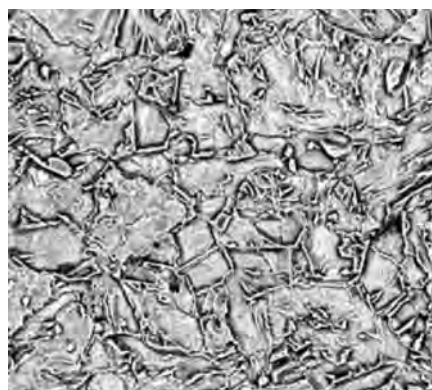
Рис. 5. Морфология выделения бейнитной составляющей в структуре металла ОШУ ЗТВ стали K70 после воздействия двух проходов
