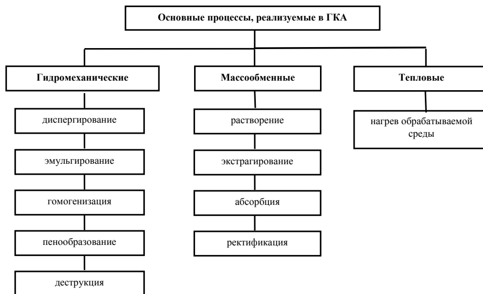
Рис. 3. Схема классификации технологических процессов, реализуемых в ГКА
