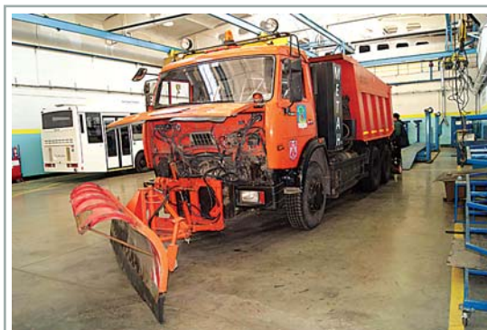
Автомобиль-самосвал ЭД-405АГ на базе шасси КАМАЗ 65115-30
