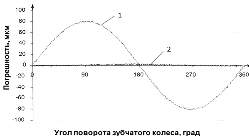
Рис. 4. Сравнение графиков кинематической погрешности эталонного колеса (2) и колеса с эксцентриситетом (1)
