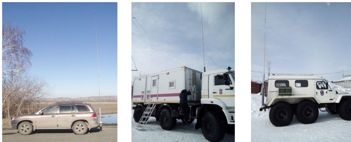
Рис. 2. Размещение антенн средневолнового диапазона на легковом автомобиле и на аварийно-спасательных машинах на базе КАМАЗ 4803 и ТРЭКОЛ-39294
