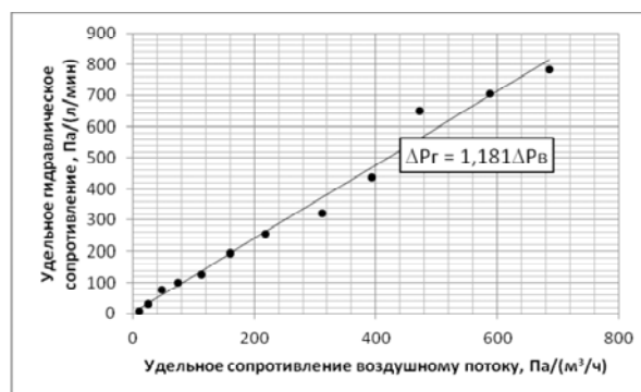
Рис. 6. График зависимости удельного гидравлического сопротивления фильтроэлемента от его удельного сопротивления воздушному потоку
