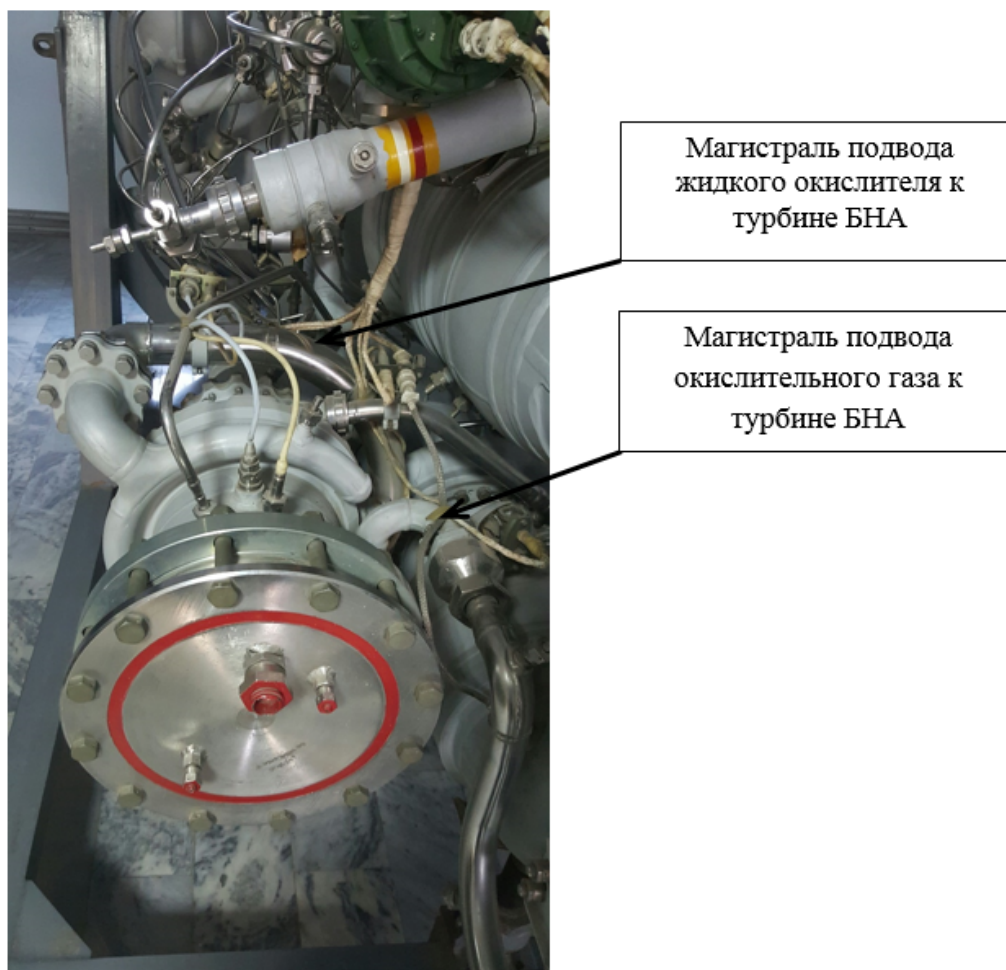
Рис. 2. Подвод рабочего тела на привод БНА окислителя
