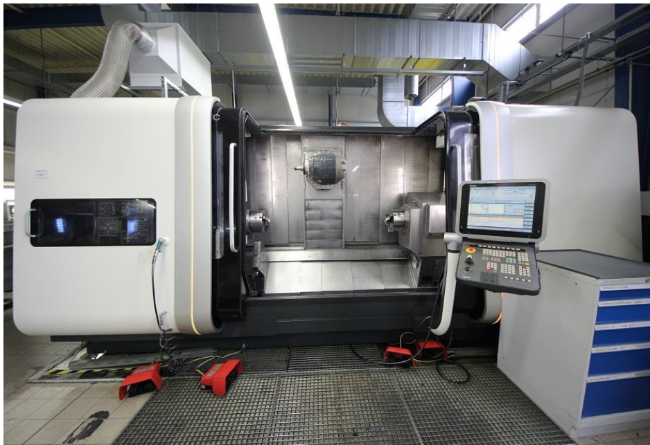
Рис. 2 – Общий вид многооперационного станка модели gamma 2000 TC серии CTX
