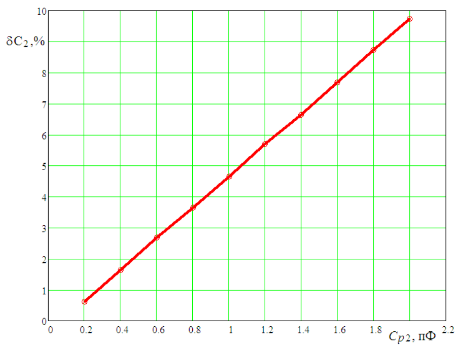
Рис. 8. График зависимости погрешности измерения параллельной емкости ПКЭ от монтажной емкости соединительного устройства
