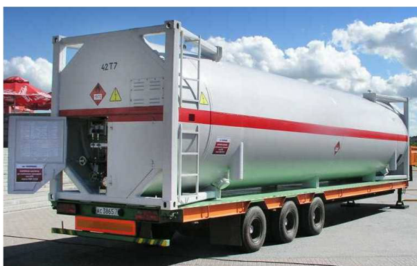
Рис. 6. Контейнер-цистерна модели КЦМ-35/06 для транспортировки СПГ
