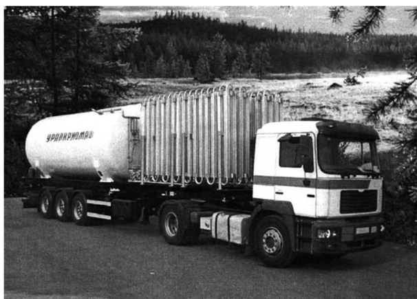
Рис. 10. Криогенный транспортный комплекс контейнер-цистерна и газификатор
