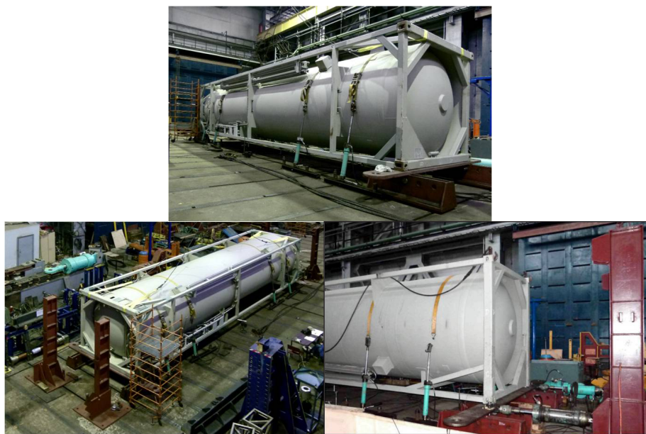
Рис. 9. Статические испытания контейнера-цистерны модели КЦМ-40/0,7
