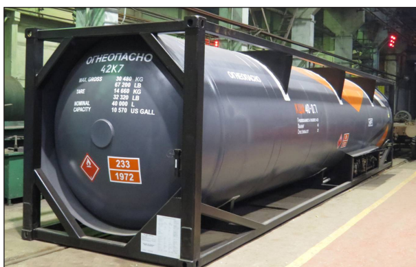
Рис. 8. Контейнер-цистерна модели КЦМ-40/0,7 для транспортировки СПГ и этилена
