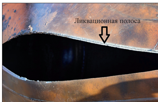
Рис. 4. Разрыв металла катушки КЗ в продольном направлении по всей длине катушки 1270 мм с раскрытием до 150 мм на расстоянии 100 мм от продольного шва
