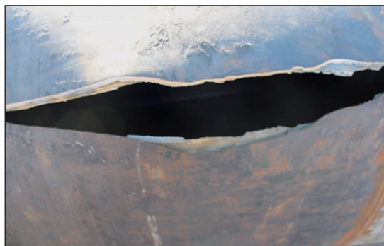
Рис. 2. Расслоение стенки металла K1 по длине разрыва 1000 мм с раскрытием до 120 мм
