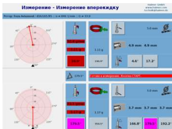
Рис. 5. Качество динамической балансировки инструментальной наладки AZ-3D16R6L65 согласно требованиям ISO 1940-1
