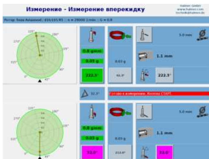
Рис. 8. Результат балансировки инструментальной наладки фрезы AZ-3D16R6L65
