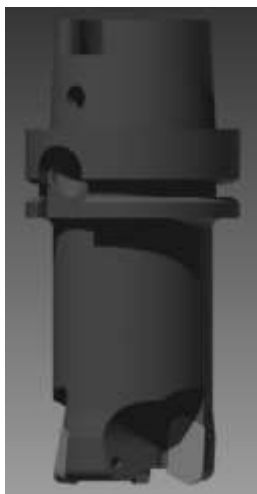
Рис. 1. 3D-модель сборной фрезы R790 со сменными твердосплавными пластинами
