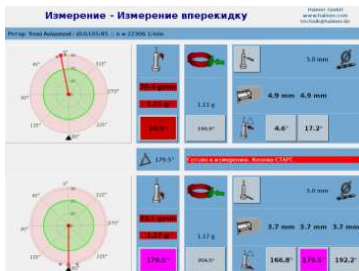
Рис. 6. Качество динамической балансировки инструментальной наладки AZ-3D16R6L65 согласно требованиям DIN 69888
