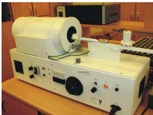
Рис. 6. Установка по размагничиванию переменным магнитным полем AF-Demagnetizer
