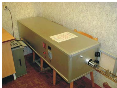
Рис. 7. Установка по размагничиванию температурой MMTD80
