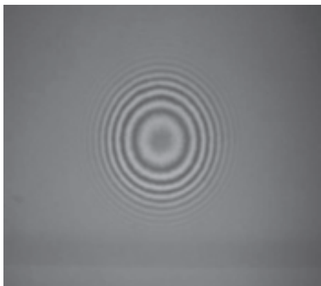
Рис. 2. Интерференционная картина в момент измерения
