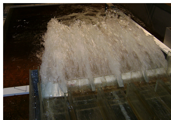
Рис. 4. Работа отклонителя струи
