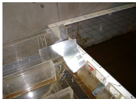
Рис. 3. Ступенчатый отклонитель струи пролета № 1
