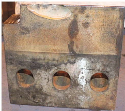
Рис. 1. Сработанный нож гидравлических пресс-ножниц
