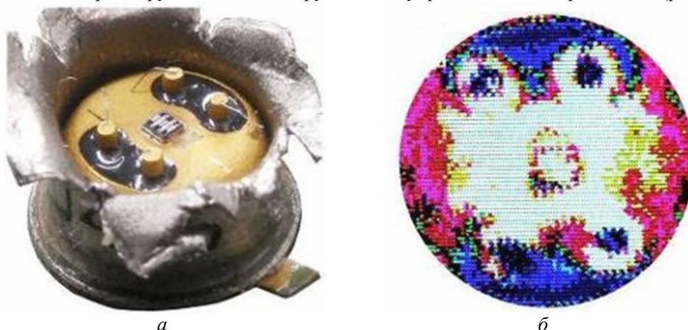
Рис. 4. Внешний вид (а) и лазерная фотоакустическая топограмма (б) прибора 1а
