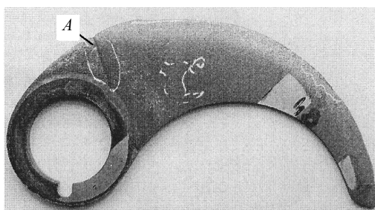
Рис. 2. Вид ножа, упрочненного объемной закалкой, после эксплуатации
