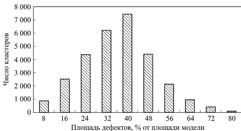
Рис. 7. Гистограмма распределения значений площадей дефектов при образовании сверхпроводящих кластеров
