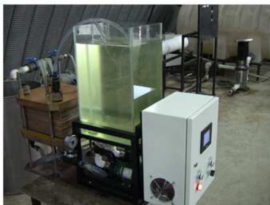
Рис. 3 – Общий вид пилотной электродиализной установки
