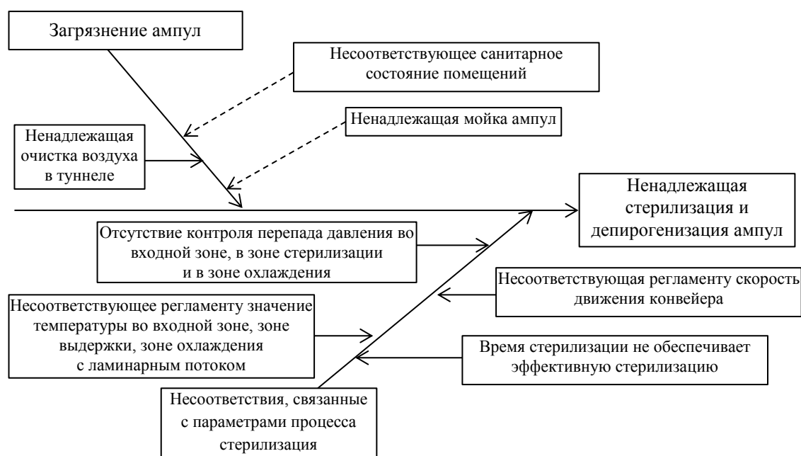
Рис. 3. Фрагмент диаграммы Исикавы применительно к рискам стадии стерилизации и депирогенизации ампул технологического процесса фармацевтического производства
