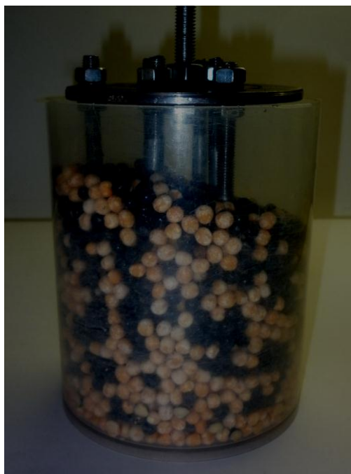
Рис. 1. Схема (а) и модель с прозрачной стенкой (б) помольного устройства
