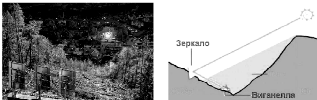
Рис. 2. Зеркала на вершине горы в г. Рjukanе (Норвегия) и д. Виганелла (Италия) (источник: http://www.rusrep.ru/article/2013/10/31/sun/ http://vokrugmir.ru/iskusstvennoe-solnce-dlya-zhitelej-italyanskoj-derevni/ )
