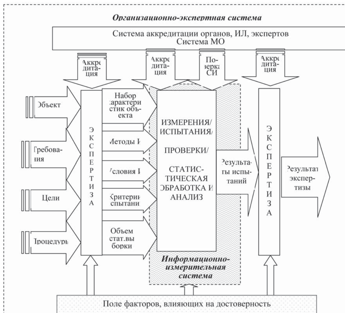
Рис. 1. Структура комбинированной организационно-экспертной и информационно-измерительной системы
